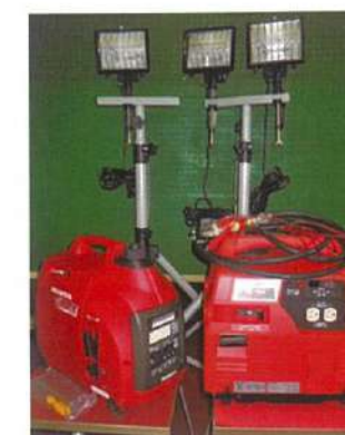
発電機と三脚付投光器
