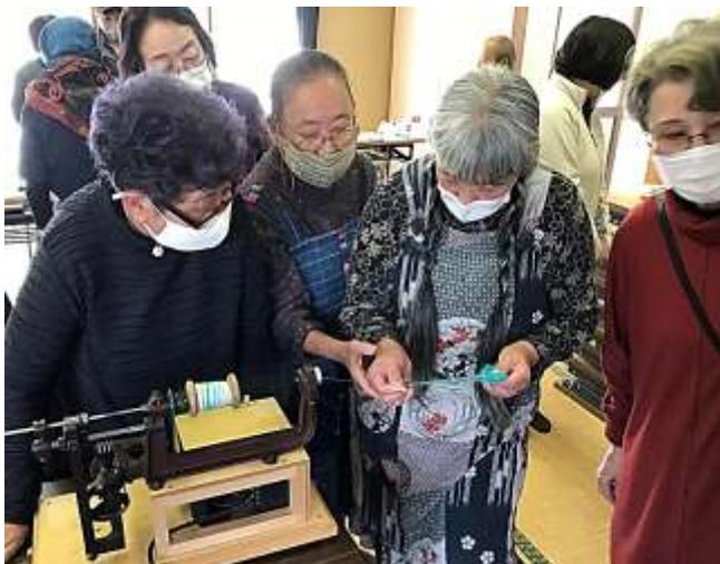
紬機「電動フライヤー」により天蚕繭の紬実習(天蚕の青染試材)
