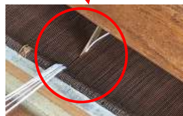
幅1cmに約10本の割合で糸を通す細心の作業 ↑
