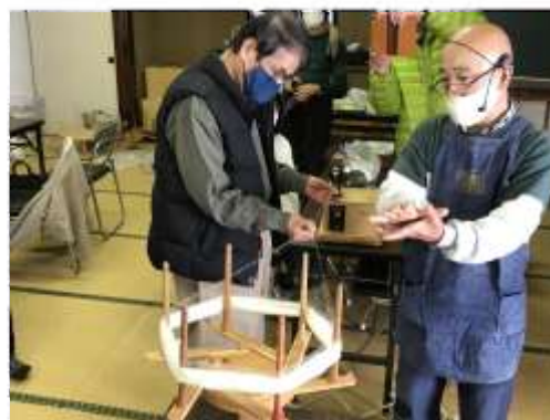
真綿を引き伸ばし「電動フライヤー」に導く
