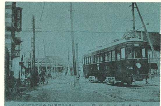
写真8 福島駅前を走る1号電車 軌間3呎6吋 電動機35IP×2 車台4輪ボギートラック 直流600V架空単線式 定員42名
